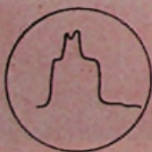
Fig. 10. Spanning tussen basis van TS506 en massa.
