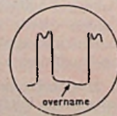
Fig. 11. Spanningsverloop aan de emitter van TS506.
