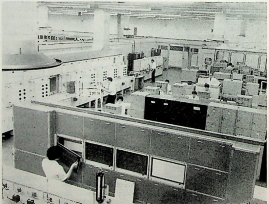
Afb. 2. Een overzicht op de afdeling voor kwaliteitscontrole, waar de halfgeleiders gedurende 9 maanden intensief worden getest alvorens ze worden vrijgegeven voor het gebruik in onderzeekabel-repeaters.
